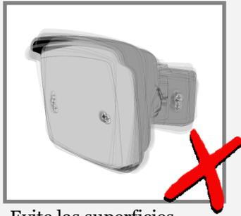
Evite las superficies inestables y sujetas a vibraciones.
